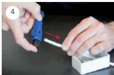
Afsoler kablet som vist på tegningen eller anvend en kabelstripper som vist på billedet
