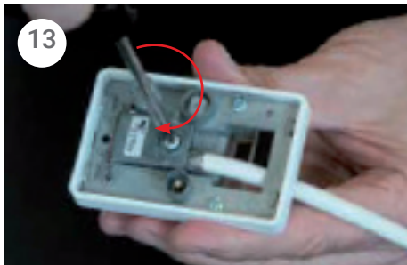
Spænd skruen på dækslet godt fast - dækslet virker som trækaflastning af kablet
