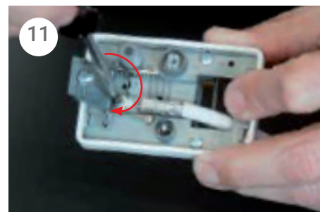
Skruen til inderlederen fastspændes og dækslet vippes ned på plads
