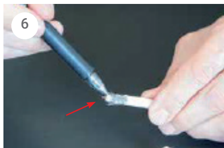
Kontroller at ingen løse tråde fra skærmen berører inderlederen og forårsager kortslutning
